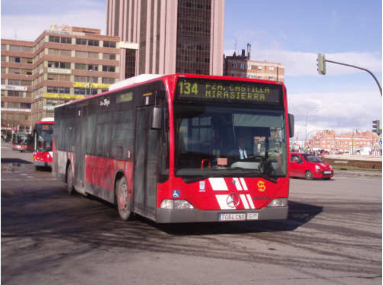
Un Mercedes Benz O-530 Citaro de la EMT de Madrid, fotografiado por David Arriola el pasado mes de febrero. Éste es uno de los 1.601 autobuses de la flota de la EMT madrileña dotados de rampa y de piso bajo.
